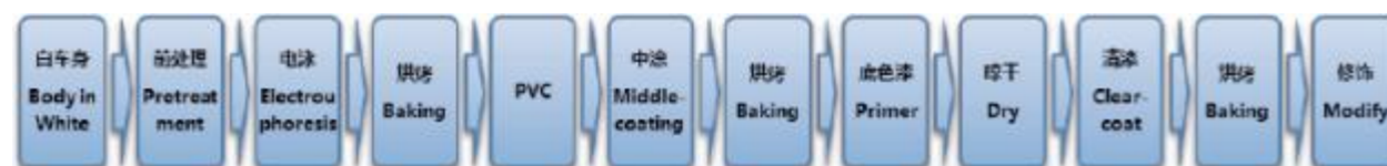
涂装基本工艺流程示意图 (Typical coating process)
